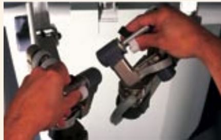
De Da Vinci is een robot met minuscule handen die in het lichaam de bewegingen van de chirurg nabootsen en creëert de mogelijkheid om ingewikkelde heelkundige procedures met een minimaal-invasieve techniek uit te voeren.
